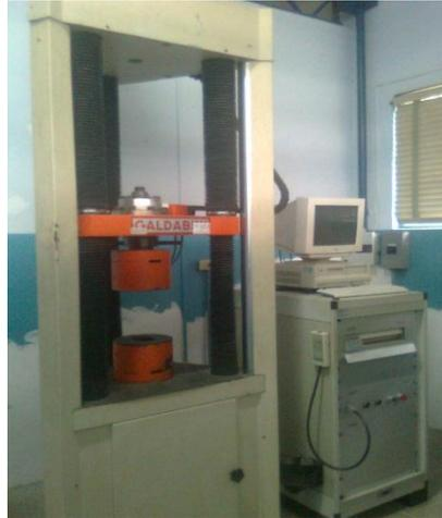
**Figura 3.4.** Equipo empleado para realizar los ensayos de compresión.
