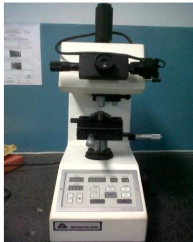
**Figura 3.2.** Microdurómetro empleado durante los ensayos de microdureza Vickers.
