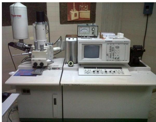
**Figura 3.5.** Microscopio utilizado para la observación de microestructuras y análisis elemental.
