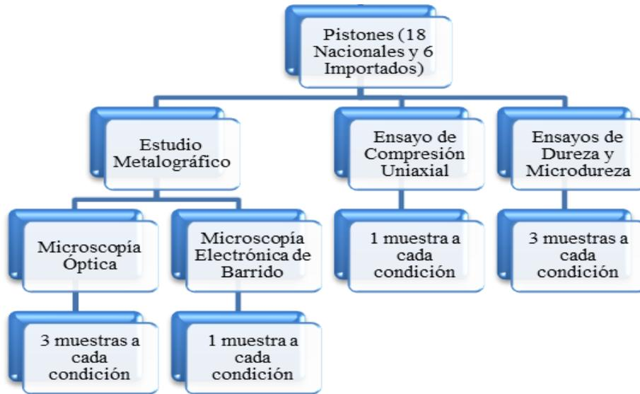
**Figura 3.9.** Flujograma resumen de todos los ensayos aplicados a los pistones sinterizados.
