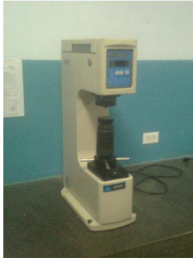
**Figura 3.3.** Durómetro empleado para los ensayos de dureza Rockwell F.
