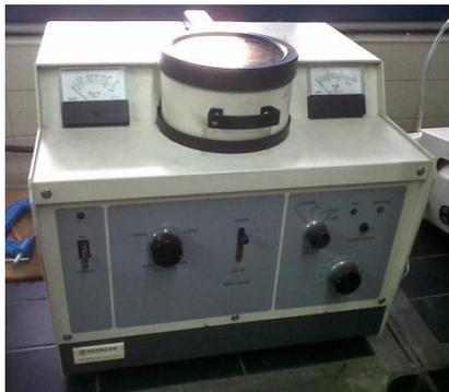
**Figura 3.7.** Equipo empleado para eliminar los restos de óxido en las muestras.
