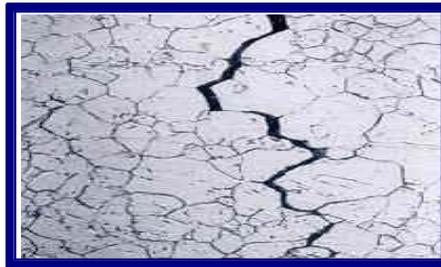
Figura 7: Fotografía microscópica de falla Intergranular. (Fontana 1986)
