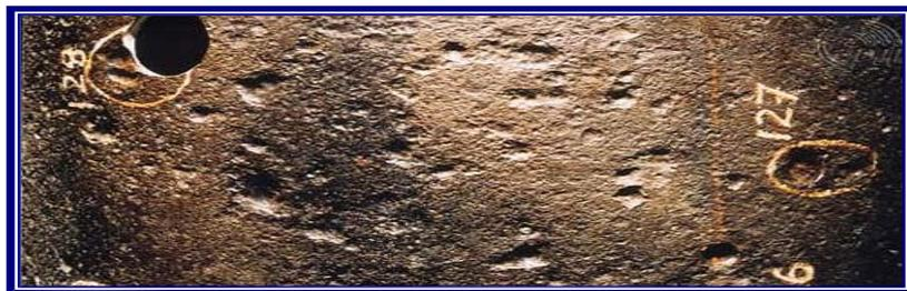
Figura 5: Corrosión por Picaduras en una tubería API-5L grado B. (UNLP 2007)
