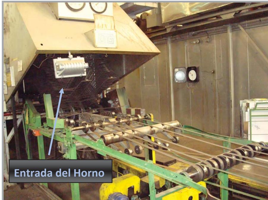
Figura. N° 4.7. Entrada del Horno.
