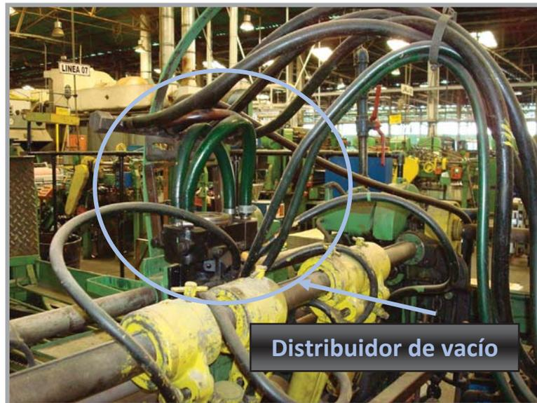
Figura. N° 4.11. Distribuidor de vacío. Alimentador
