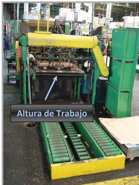
Figura. N° 4.3. Comienzo de la Línea 6 de Prensa Litográfica. Alimentador
