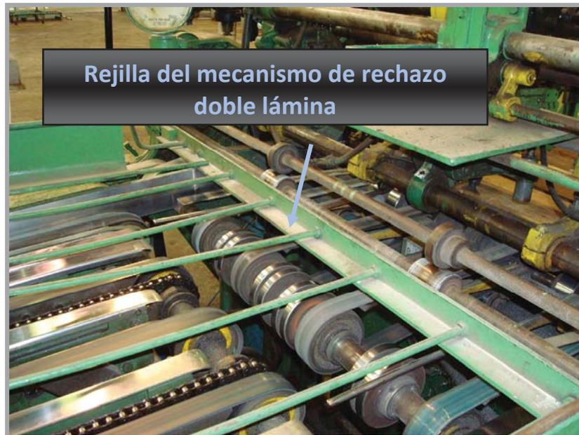
Figura. N° 4.12. Mecanismo de rechazo doble lámina.
