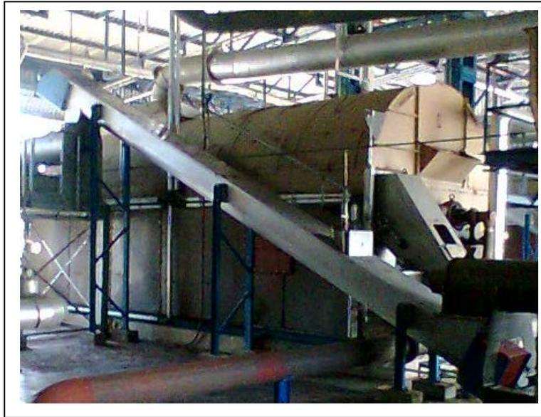
**Figura 4.4.** Tornillo sin fin de alimentación de material al proceso de secado.
