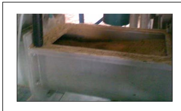
**Figura 3.13.** Ducto de recirculación del proceso de secado.
