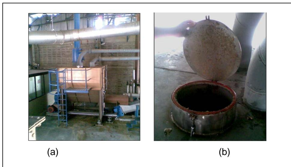
**Figura 3.8.** Tolvas de nepe húmedo. La vista (a) proporciona una imagen de la tolva completa, mientras que la (b) representa un acercamiento a la tapa de la tolva.
