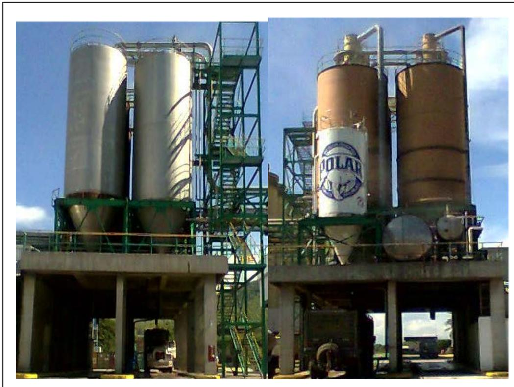
**Figura 4.5.** Silos de almacenamiento de nepe húmedo y seco.
