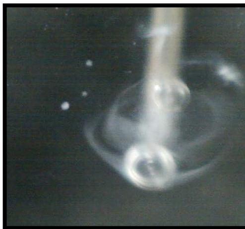
**Figura C.2.14.** Vista superior de la celda del Sistema K' (NFE-4/Igepal 710/Butanol); gota de la fase oleica que sale de la jeringa en el contenido volumétrico de agua.
