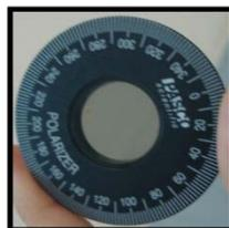
**Figura 4.22.** Polarizador utilizado en el montaje experimental para observar cristales líquidos.
