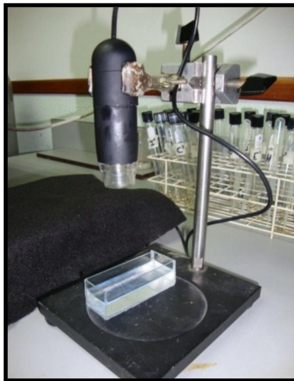
**Figura 3.12** Montaje de la microscopía óptica para la visualización desde arriba de la muestra.
