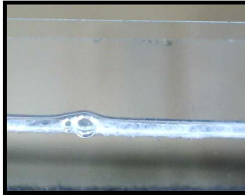
**Figura C.2.3.** Vista lateral de la celda del Sistema D (NFE-6/Igepal 730/1-propanol); formación de la emulsión en la superficie.
