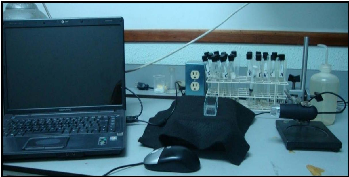
**Figura 3.11.** Montaje para la observación de una gota de aceite en un volumen de agua
