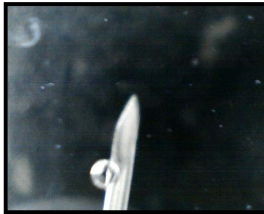
**Figura C.2.10.** Vista superior de la celda del Sistema E' (NFE-4/Igepal 630/2-propanol); gota de la fase oleica que sale de la jeringa en el contenido volumétrico de agua.
