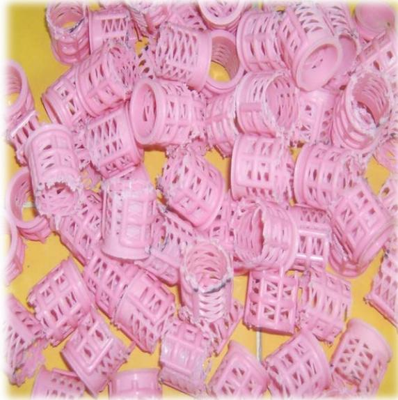
**Figura C.7. Anillos Pall de plástico.**
