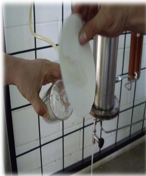
**Figura C.2 Prueba con nitrato de plata.**
