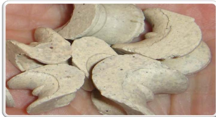
**Figura 2.8. Rellenos para torres de absorción.**
