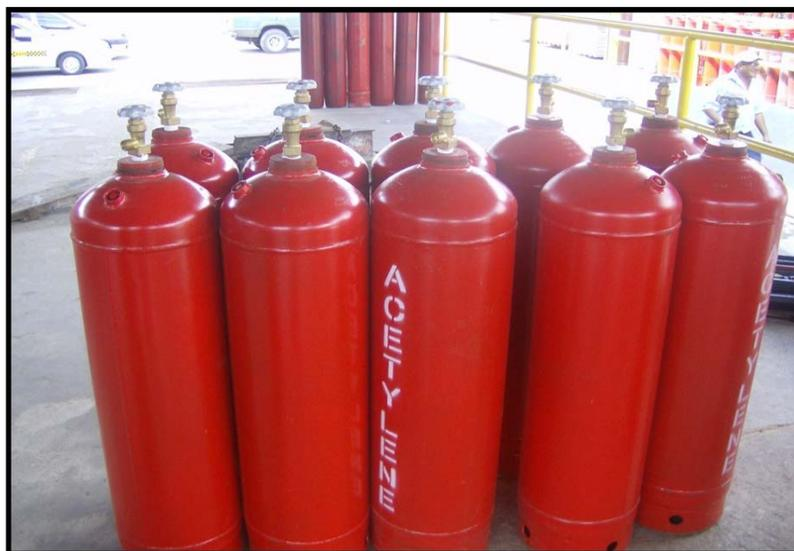
**Figura 2.4 Cilindros de acero para almacenamiento del acetileno.**
