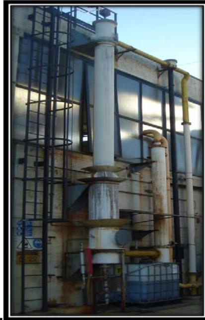
**Figura 3.5. Absorción con una torre de ácido sulfúrico.**
