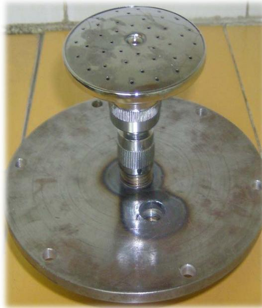
Figura C.3 Dosificador de ácido sulfúrico.
