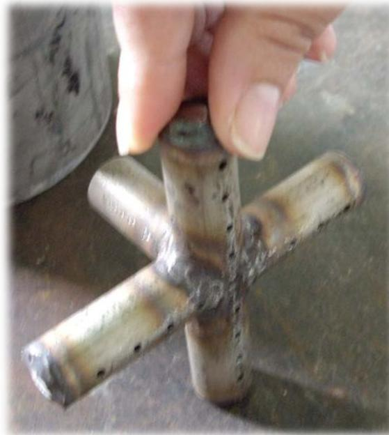
**Figura C.5. Distribuidor de gas en el sistema piloto**
