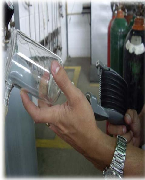
**Figura C.1 Prueba con tubos colorimétricos.**
