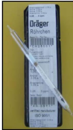
**Figura 2.6 Tubos colorimétricos para medición de gases.**
