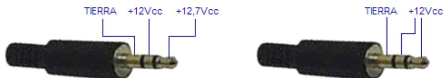
Figura 4.5 Izquierda: conexión original; derecha: conexión con baterías
