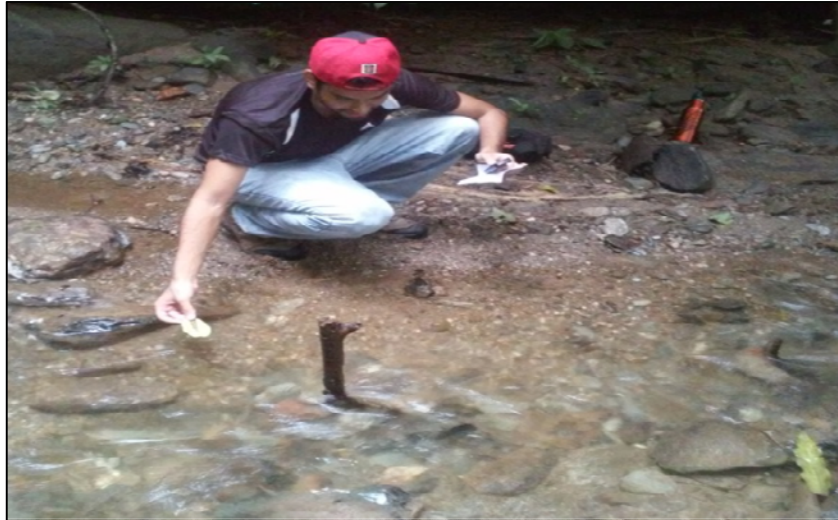
Figura 3. Mediciones de caudal (Punto A de partida el flotador).
