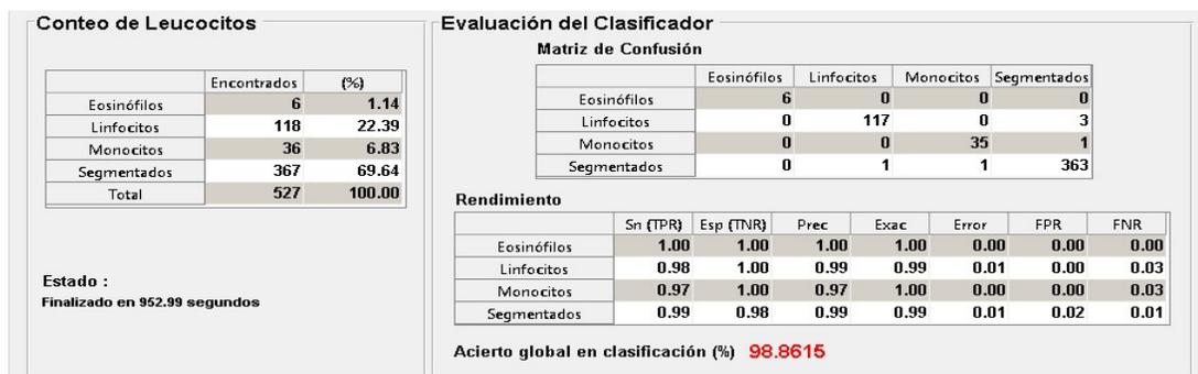
*Figura . Resultado clasificación imágenes BDL usando criterios de rechazo de la Tabla .*
