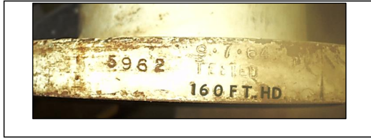
Figura 4.18. Altura de diseño de la Turbina Francis.
