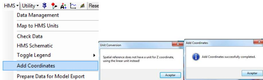
**Figura 158. Procedimiento para agregar coordenadas.**
