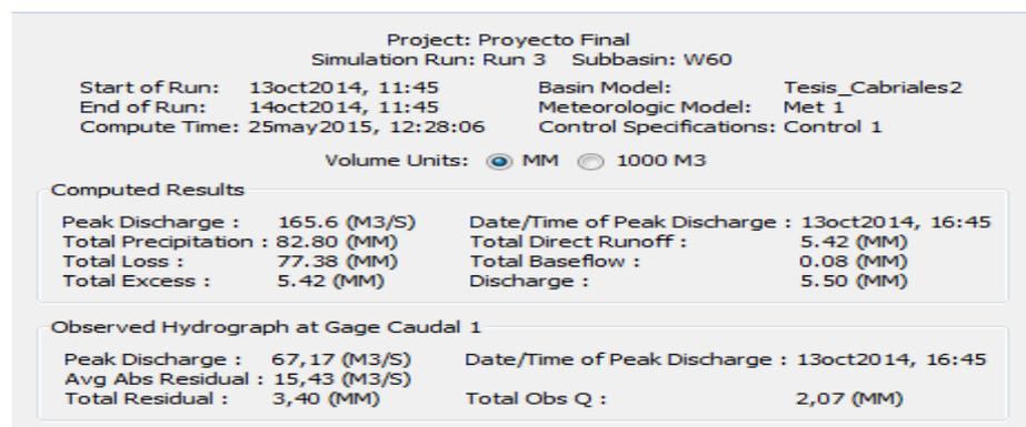
**Figura 186. Resultados obtenidos por el método SCS Unit Hydrograph.**
