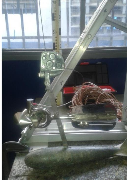
**Figura 31. Hélice del Correntímetro y Tiburon.**
