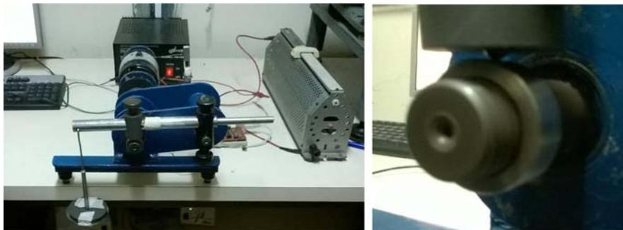
Figura 3. 4. Esquema de la máquina para ensayos de fricción y desgaste por deslizamiento
