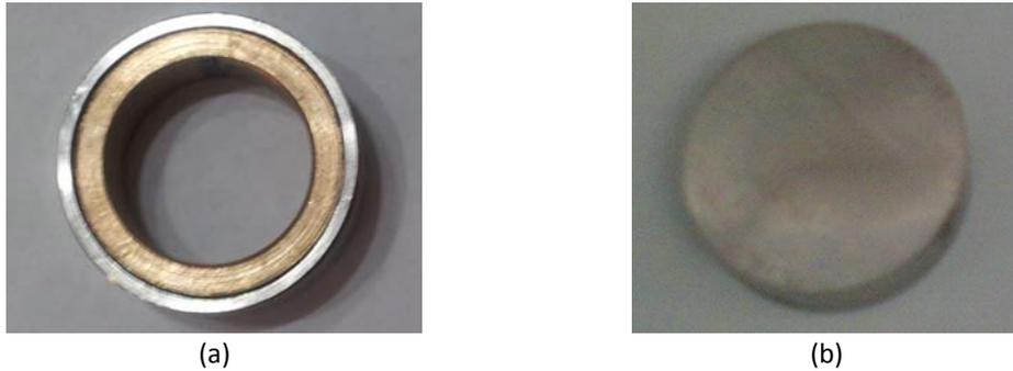
**Figura 3. 3. Especímenes de prueba (probetas) para los ensayos en tribómetro (a) Deslizamiento (b) Frotamiento**
