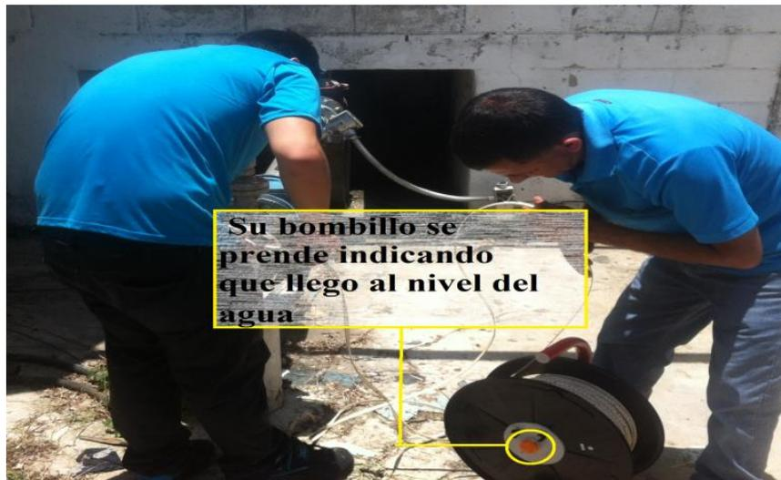
Figura 9 Toma de nivel del agua con la sonda
