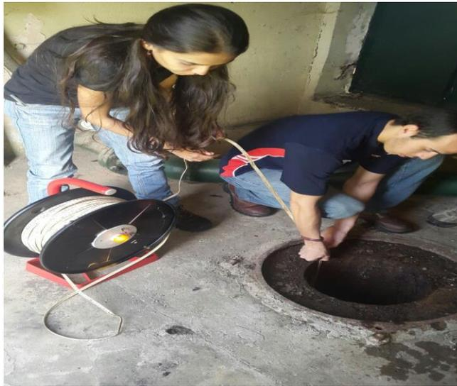
**FIGURA 16.**Medición de Niveles en el pozo N°3 de Bigott. Coordenadas UTM 613950E; 1127884N. Elevación: 434 msnm. Zona Industrial Castillito, Municipio San Diego, Estado Carabobo. Fecha: 15/09/16.
