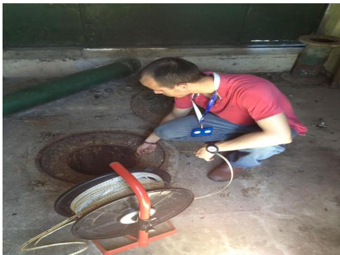
**FIGURA 20.**Medición de Niveles en el pozo N°3 de Bigott. Coordenadas UTM 613950E; 1127884N. Elevación: 434 msnm. Zona Industrial Castellito, Municipio San Diego, Estado Carabobo. Fecha: 24/10/16.
