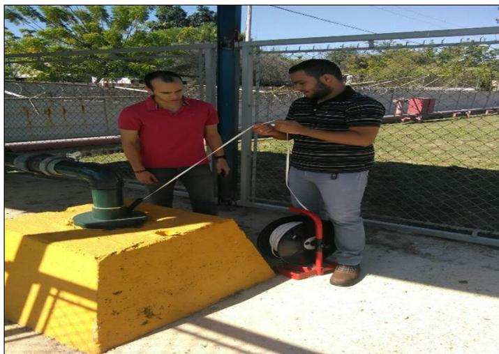
**FIGURA 18.**Medición de Niveles en el pozo N°13 de Proagro. Coordenadas UTM 614670E; 1126502N. Elevación: 451 msnm. Zona Industrial Castellito, Municipio San Diego, Estado Carabobo. Fecha: 24/10/16.
