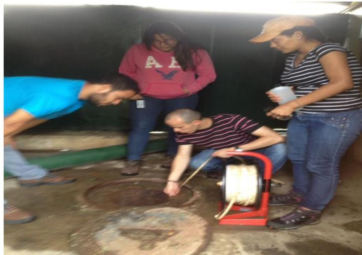
**FIGURA 17.**Medición de Niveles en el pozo N°3 de Bigott en compañía de la representante Adriana Marco. Coordenadas UTM 613950E; 1127884N. Elevación: 434 msnm. Zona Industrial Castillito, Municipio San Diego, Estado Carabobo. Fecha: 22/09/16.
