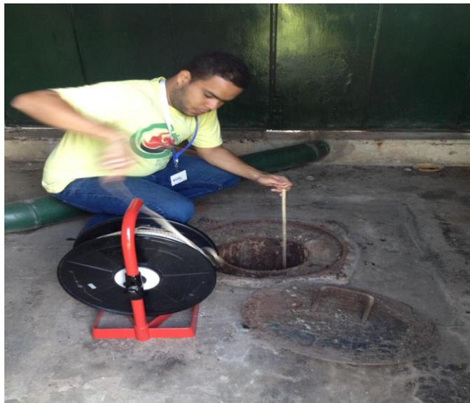
**FIGURA 15.**Medición de Niveles en el pozo N°3 de Bigott. Coordenadas UTM 613950E; 1127884N. Elevación: 434 msnm. Zona Industrial Castillito, Municipio San Diego, Estado Carabobo. Fecha: 12/09/16.
