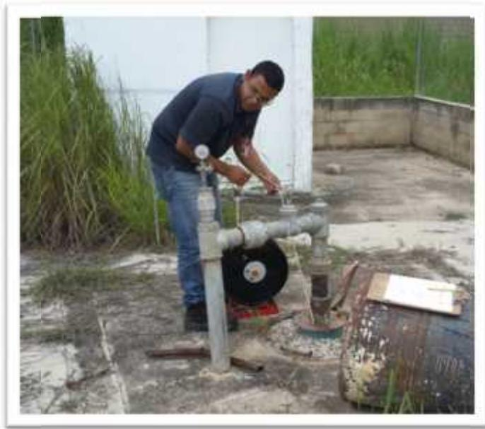
**Figura 1.** Medición de Niveles Estáticos en el pozo La Cumaca
