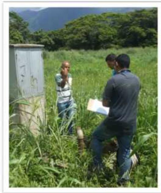
**Figura 2.** Medición de Niveles Estáticos en el pozo Villas San
