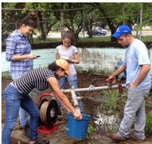
Ilustración 7 Medición de nivel de pozo # 6 A.C conjunto residencial El Tulipán. Coordenadas 613.536,88E; 1.134.540,80N elevación 480 m.s.n.m. Fecha 22/09/2016. Fuente los Autores
