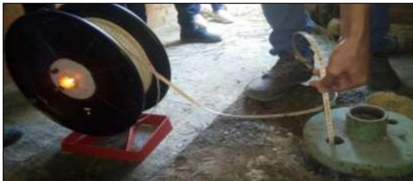
**FIGURA 9.**Medición de nivel Estático y Dinámico.
