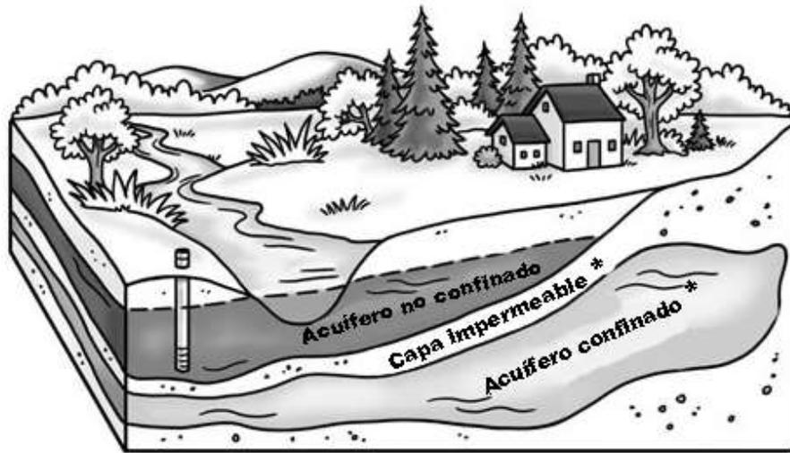
**FIGURA 1.** Tipos de acuíferos según la presión hidrostática.
