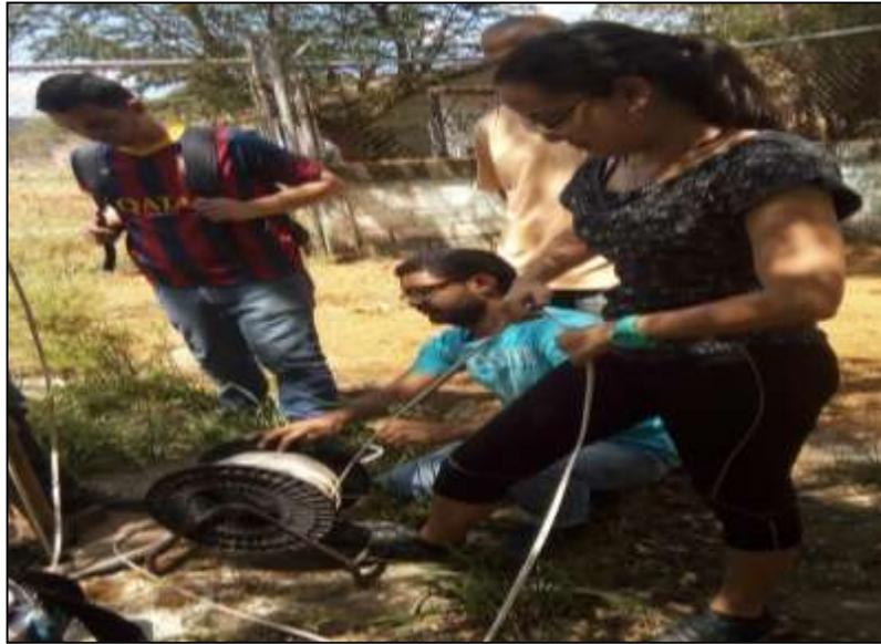
**ANEXO C.** Medición de nivel con sonda.
