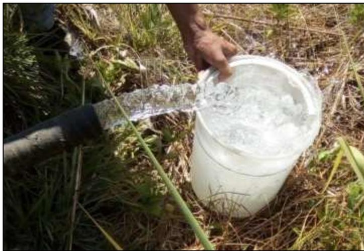
**FIGURA 10.**Medición del Caudal con tobo graduado.
