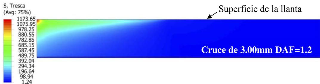
Figura 59: Esfuerzos de Tresca debajo de la superficie en una sección de la llanta para cruce de rodillo radial de 3.00 mm, en MPa con DAF=1.2
