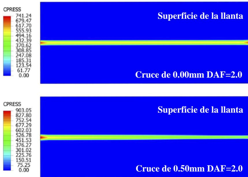
Figura 52: Distribución de presión de contacto sobre la superficie de la llanta, en MPa, para cruce en rodillo radial de 0.00 y 0.50 mm con DAF=2.0
