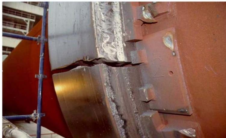
Figura 19: Fractura de llanta por grieta.
