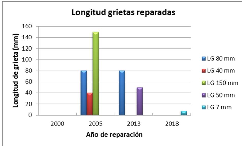
Figura 83: Resumen de grietas reparadas y año de reparación.
