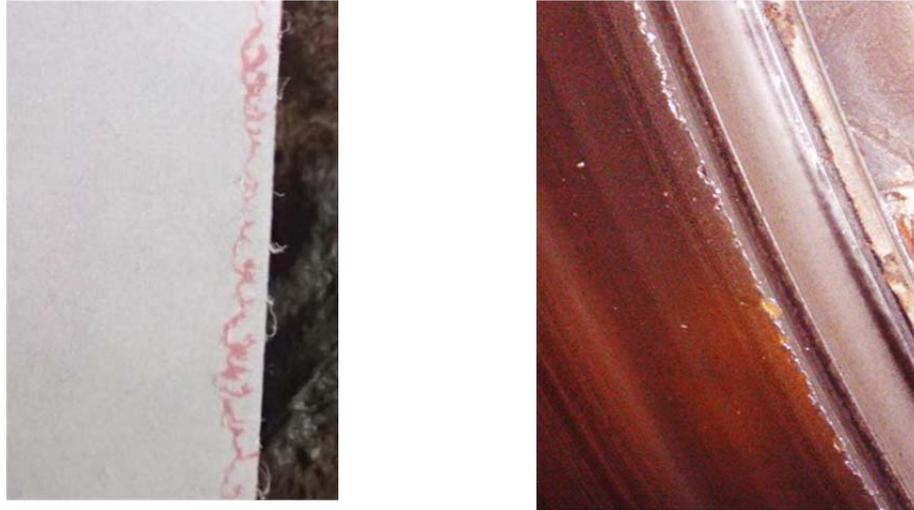
Figura 3: Inicio de grietas en la orilla de la llanta de TR-401
