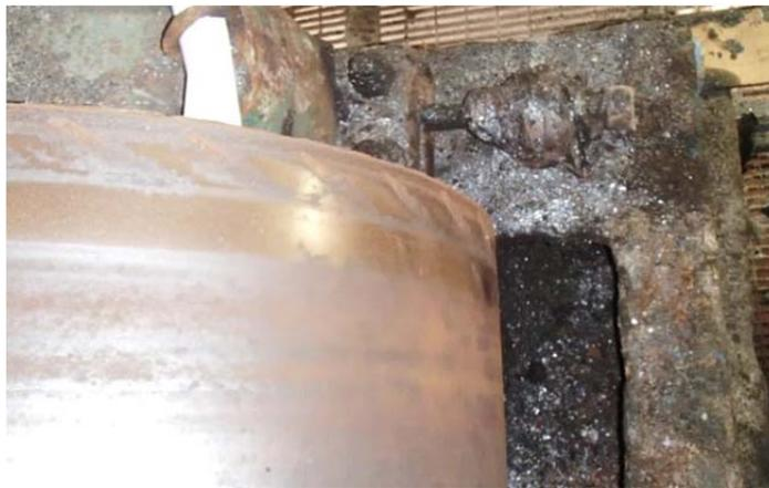
Figura 6: Hojuelas metálicas por desgaste de llanta de TR-401
