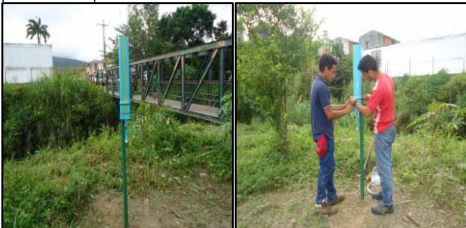
**Figura 40.** Instalación de los pluviómetros en la CPLA-MN
