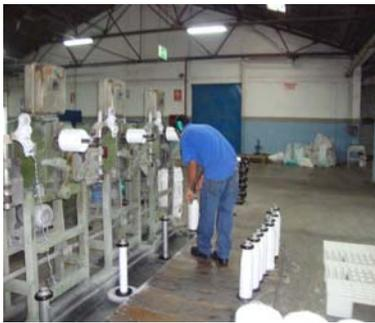
Colocacion de Bobinas en carretos. Operador de Mecates
