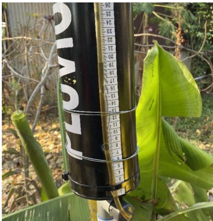
Figura 26. Prueba de lectura de la cantidad de agua almacenada.
