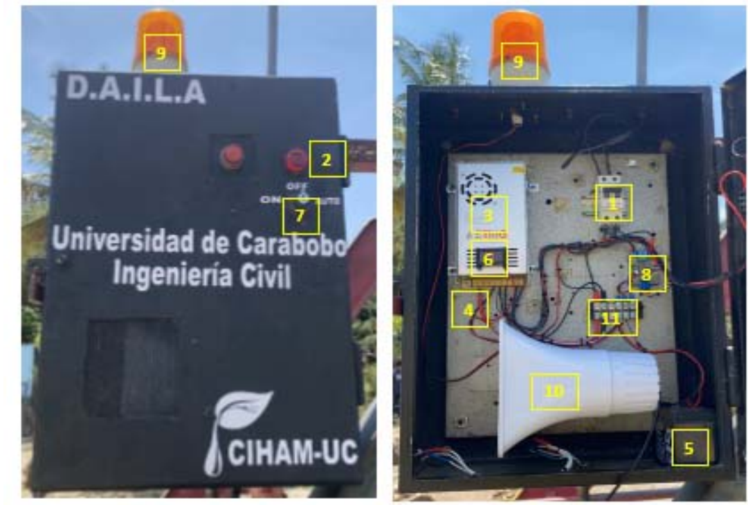
Figura 34. Componentes del Dispositivo de Alerta ante Inundaciones Las Adjuntas. Fuente: Colmenares I. (2023)
